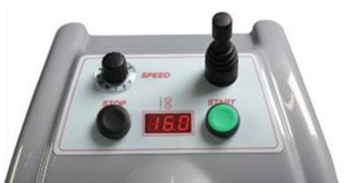
SF 500VD (Variabel hastighed mellem indførrings-og aflader bånd. Valseafstand aflæses på digitalt display)
